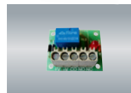
UTKRL01V12A03 circuiti relè
