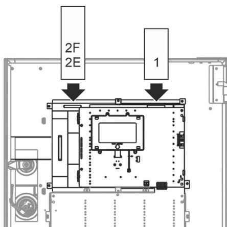
Gli inserti sono numerati da 1 e 2F/2E e sono inseriti nella posizione indicata (con l'area stampata rivolta verso la parte anteriore della centrale).
